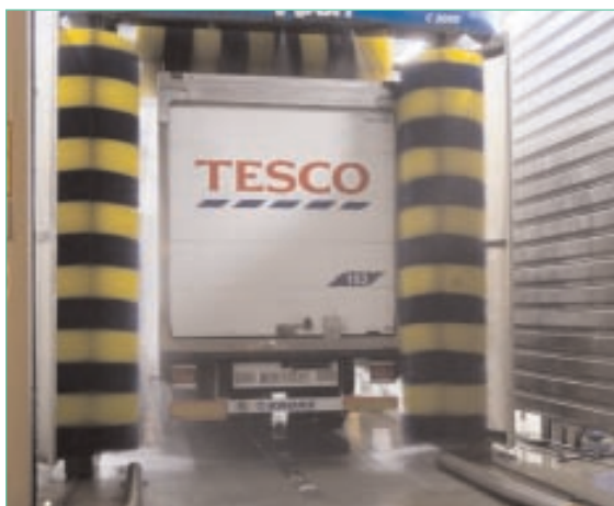
Myjnia dla naczep z zamkniętym obiegiem wody w centrum dystrybucji Tesco
